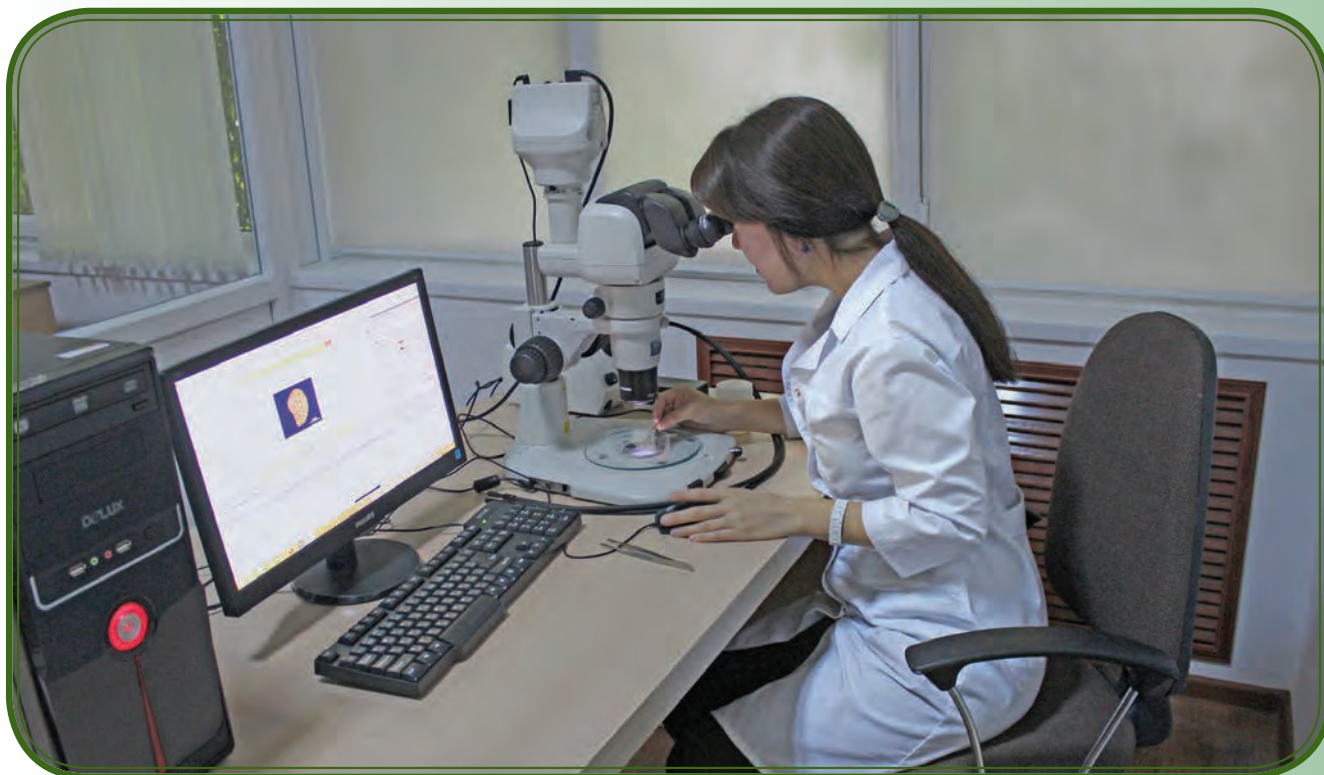
Стереомикроскоп Nikon SMS 800 N. Фотографирование и описание семян
